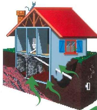
Le gaz radon peut s'infiltrer dans un bâtiment à travers chaque défaut d'étanchéité (percement, trou, fissure, vide autour des canalisations et gaines techniques, etc...) situé entre le sol et le bâtiment. Il risque ensuite de s'accumuler si le renouvellement d'air dans le bâtiment est insuffisant, par exemple lorsque le système de ventilation est défectueux.
