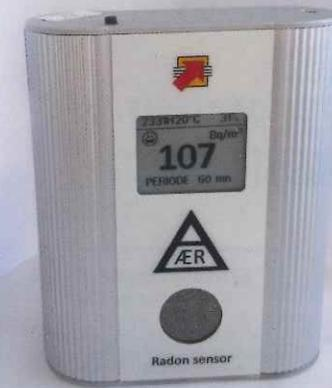
Exemple de moniteur numérique de détection du radon en temps réel.
